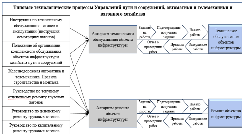
Рис. 1. Укрупненная схема типового технологического процесса обслуживания и ремонта объектов инфраструктуры
